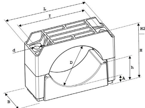
Couple de serrage pour le matériel de fixation: 5 – 8 Nm.
