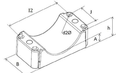
Couple de serrage pour le matériel de fixation: 5 – 8 Nm.
