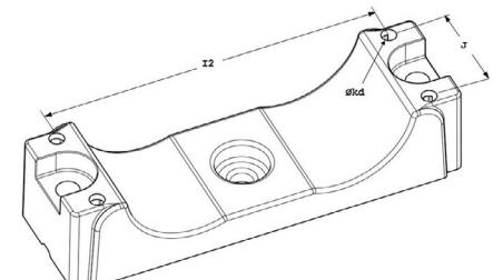
Couple de serrage pour le matériel de fixation: 5 – 8 Nm.
