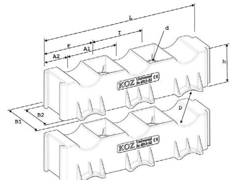
Couple de serrage pour le matériel de fixation: 5 – 8 Nm.
