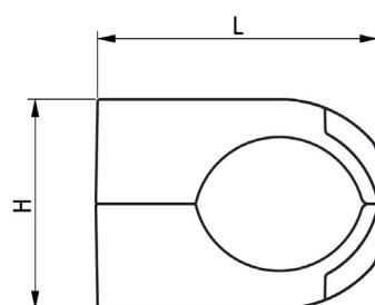
Couple de serrage pour le matériel de fixation: 5 – 8 Nm.
